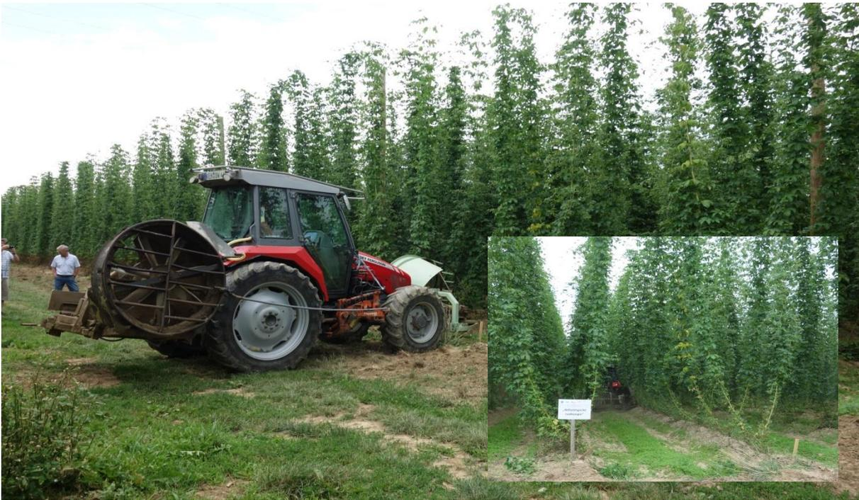
**Abb. 7: Mechanisches Hopfenputzen mittels Laubsaugereinsatz**
