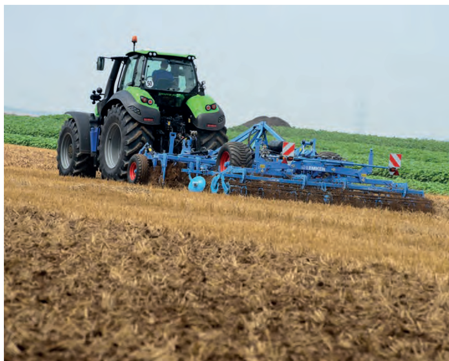
In den Demonstrationsbetrieben kamen mechanische Verfahren zur Stoppel- und Aufwuchsbeseitigung zum Einsatz.
