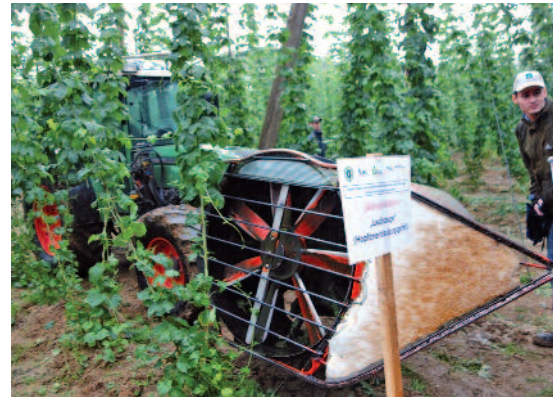
Den Teilnehmern (oberes Bild) am Feldtag auf dem Demonstrationsbetrieb Mehrl wurde neben verschiedenen anderen Varianten u.a. auch das Hopfenputzen mit Laubsauger im Frontanbau gezeigt.
