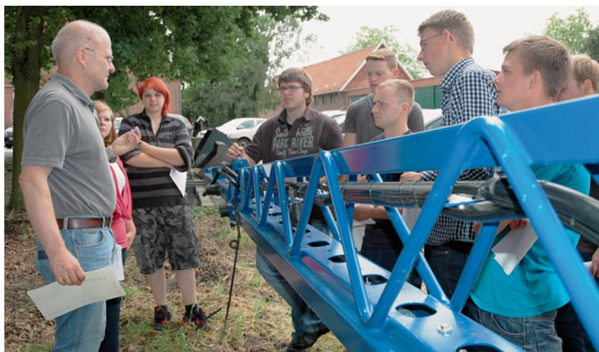
Die Pflanzenschutzspritze tut seit Januar 2013 ihre Dienste im Betrieb Peters und läuft nun die dritte Saison. Die Schülerinnen und Schüler überprüfen unter anderem den Anbau der Teile und Düsen und ermitteln die Düsenausstoßmenge.
